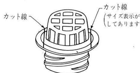
右表の△印の軒といを使用する場合はキャップのツバ面をカットして使用して下さい。
